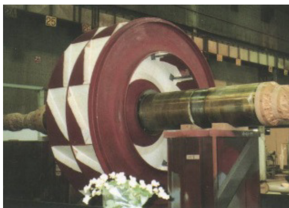
図1 セラミックライニングブロウ翼 翼板、側板の白色部:アルミナ 翼入り側の黒色部:窒化珪素、サイアロン
